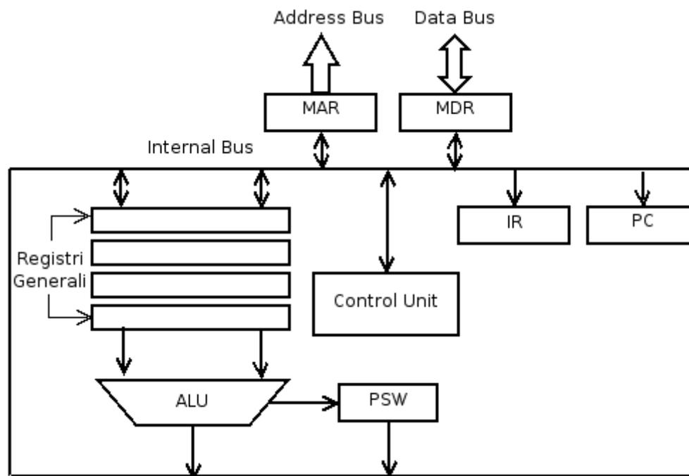
Nello schema sono riportati i componenti principali di una CPU:
