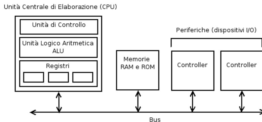
I componenti sono collegati e comunicano utilizzando stringhe binarie che vengono inserite nel bus che, sostanzialmente, si compone, concettualmente, di un insieme di fili paralleli (piste di rame nella realtà) che permettono il passaggio dei segnali elettrici fra un componente e l'altro. Quello mostrato in figura è il bus esterno; esistono anche dei bus interni, per esempio, nella CPU per permettere il passaggio di segnali fra le varie unità che la compongono.
