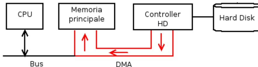
Quando la CPU riceve, da un programma, una richiesta di lettura di dati dall'hard disk, invia una richiesta al controller che a sua volta invia all'unità la richiesta per la lettura dei dati. L'unità invia i dati al controller che è in grado di scrivere o leggere in memoria senza fare intervenire la CPU, effettuando quello che viene chiamato **DMA** (Direct Memory Access).
