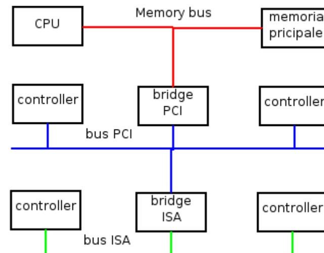
Il bus di tipo più vecchio, e lento, è il **bus ISA** (Industry Standard Architecture) sostituito nelle macchine più recenti dal **bus PCI** (Peripheral Component Interconnect) molto più veloce. La CPU dialoga con la memoria principale utilizzando un bus dedicato ad alta velocità.
